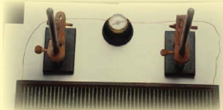
En opstilling af H.C. Ørstedes eksperiment fra 1820 til påvisning af elektromagnetismen. Når strømkredsen fra batteriet sluttes, slår kompasnålen ud på tværs af strømmen i ledningen. Opdagelsen revolutionerede både vores videnskab og samfund.
